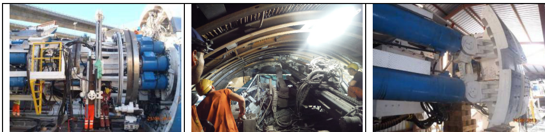
Figura 7. Erettore e perforatrice (a), sonda (b), gripper e cilindri di spinta (c)
